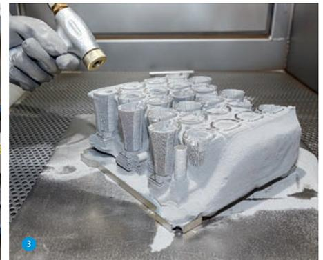
LINK verfügt über mehrere dieser innovativen Anlagen für die additive Fertigung (1). Nach dem Ende des Fertigungsverfahrens wird der pulverige »Kuchen« aus der Maschine gezogen (2). In einer speziellen Strahlkabine werden die frisch gefertigten Implantate freigelegt (3). Oben: Zusammenstellung per additiver Fertigung hergestellter LINK Produkte.
