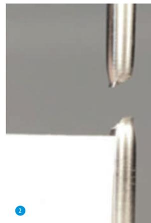
Die Kobalt-Chrom-Probe (CoCrMo, Abbildung 1) weist eine höhere Zugfestigkeit auf als die Edelstahlprobe (M30NW, Abbildung 2). Die durchschnittliche Zugfestigkeit beträgt bei der Edelstahlprobe 1.087 +/- 25,67 MPa, bei der Kobalt-Chrom-Probe 1.357,08 +/- 44,59 MPa. Die Einschnürung beim Bruch der Edelstahlprobe deutet auf einen Zähbruch hin, während die Kobalt-Chrom-Probe eher einen verformungsarmen Bruch zeigt und für ein sprödes Werkstoffverhalten spricht.
