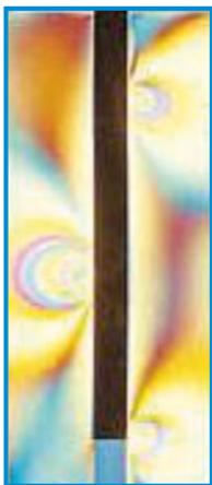
Geradschäfte produzieren in einem anatomisch s-förmigen Markkanal Belastungsspitzen
